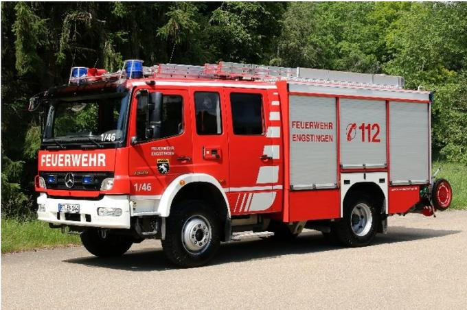
**Hilfeleistungs-Löschgruppenfahrzeug HLF 20/16 1/46**
